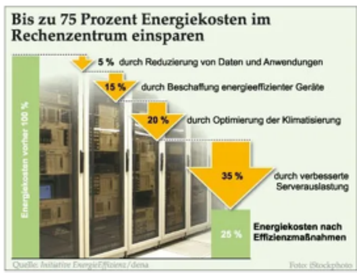
Abbildung 1: Einsparen der Energiekosten im Rechenzentrum 2
